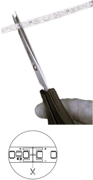
Den flexiblen LED-Streifen auf die gewünschte Länge kürzen. Die minimale Anschlusslänge beträgt 0,75 m. Beim Trennen in der Mitte des Löt pads schneiden. Scharfes Werkzeug wie z. B. Elektroniker-Seitenschneider oder Schere verwenden.
