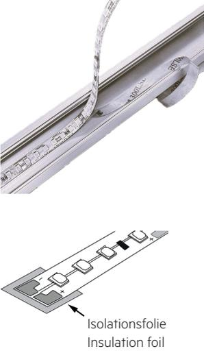
Das Tape auf einen festen, wärmeleitfähigen Untergrund kleben z.B. ein Aluminium-Profil. Die Fläche muss staub- und fettfrei sein. Ein minimaler Biegeradius von 2 cm muss eingehalten werden. Der LED-Streifen darf nicht auf normal entflammaren Materialien wie z.B. Holz montiert werden. Den LED-Streifen vor Staub und Schmutz schützen.
