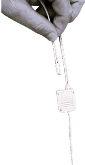
Den LED-Streifen an den 2-Fach-Stecker anschließen. Überschüssiges Kabel aufwickeln. An beiden Enden der 5m-Rolle ist ein Anschlusskabel angebracht.
